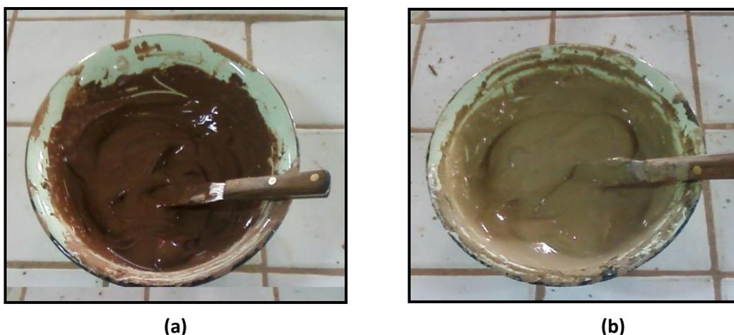
**Fig. 3.12** — Préparation de la pâte du sol avec de l'eau distillée en présence ou en absence du sulfate pendant 1, 15 et 30 jours, (a): sol argileux rouge, (b): sol argileux gris.
