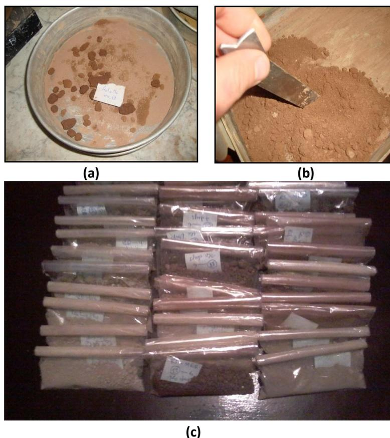
**Fig. 3.15** — Préparation des combinaisons pour la confection et le compactage, (a): humidification, (b): malaxage, (c): conservation pendant une heure.
