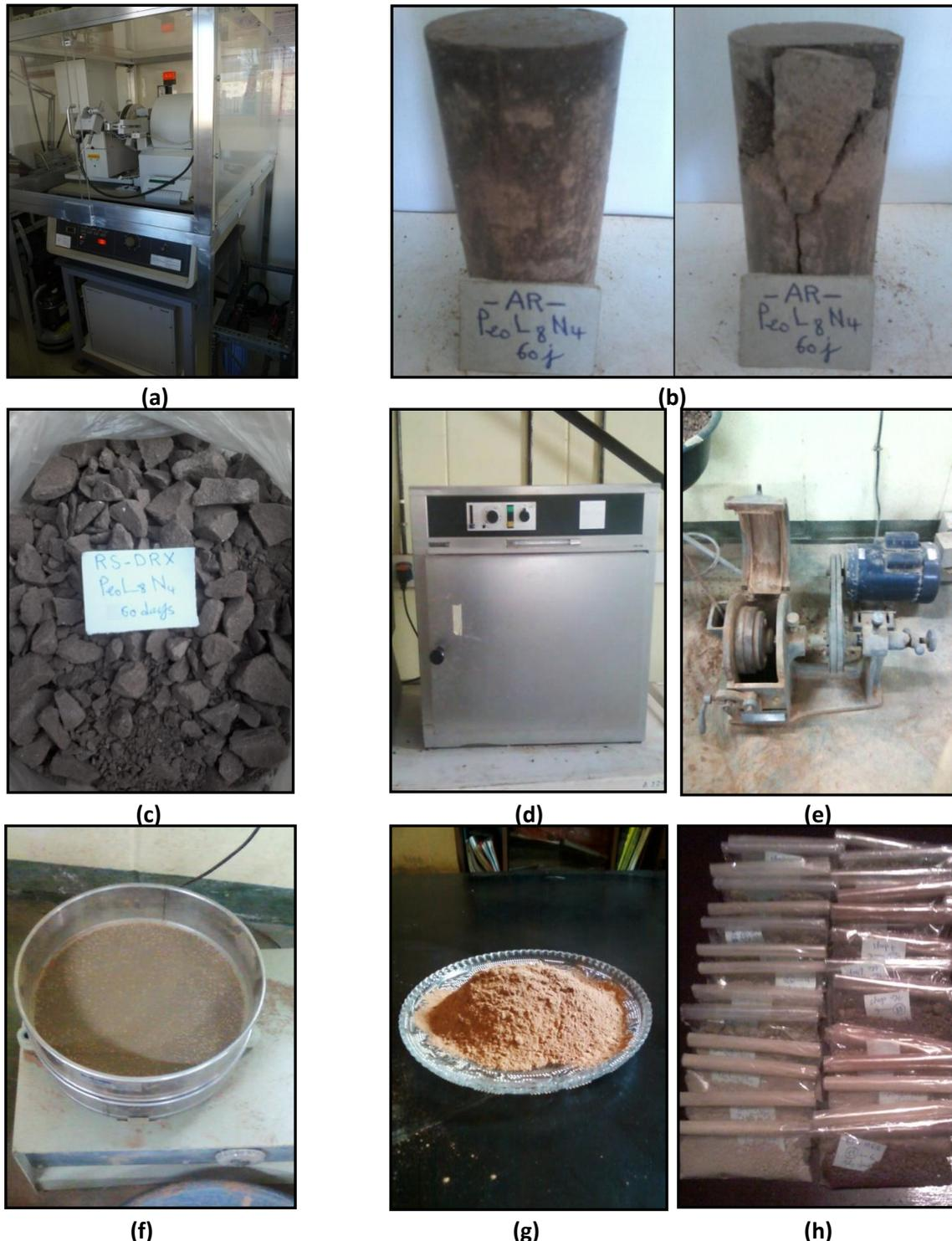
**Fig. 3.21** — Analyse minéralogie par diffraction des rayons X, (DRX), (a): diffractomètre de type Philips PW3020, (b): éprouvette du sol rouge (ex: P20L8N4 après 60 jours de cure) avant et après écrasement, (c): récupération des petits fragments après écrasement, (d): séchage pendant 24 heures à 40°C, (e): broyeur, (f): tamiseuse, (g): poudre fine de l'échantillon P20L8N4, (h):conservation hors humidité.
